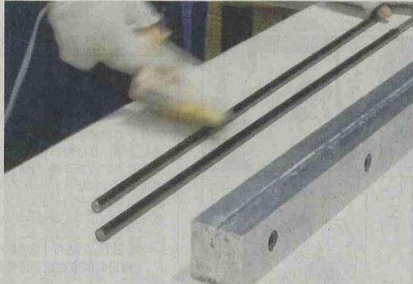
鉄芯に巻き付けたカーボンファイバーは、手作業で微調整する
